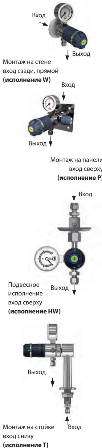
**Одноступенчатые, для инертных, реактивных, горючих и окисляющих газов и смесей, чистота макс. 6,0. EMD 3100: давление на входе 40 бар, давление на выходе 0,1-10 бар
