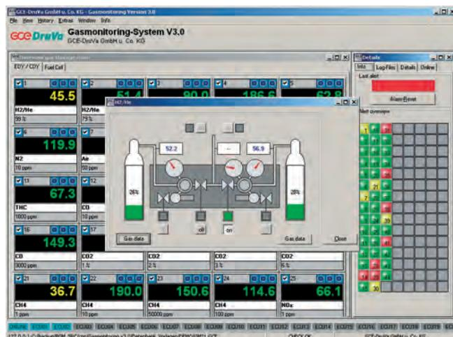
GasCom, контроль запасов и уровни давления, индикация состояний переключающих устройств, запуск циклов продувки, аварийное запирание
