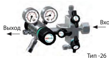
**Двухступенчатые, с продувкой инертным газом, для инертных, реактивных, горючих и окисляющих газов и смесей (кроме кислорода), чистота макс. 6,0 бар, давление в баллоне 230 бар / 3300 фунтов/кв. дюйм, FMD 522: диапазон давлений на выходе 0,2 - 3 бар абс. / 3 - 45 фунтов/кв. дюйм абс., FMD 562: диапазон давлений на выходе 0,2 - 2 бар / 3 - 30 фунтов/кв. дюйм**
