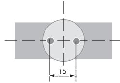
Вентиль имеет 2 отверстия M6 в днище.
