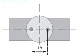
MVA 500 имеет 2 отверстия M6
