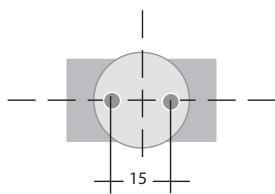
На поверхности MVR-A 400 предусмотрены 2 отверстия M6 для монтажа.
