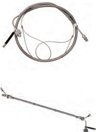
Согласно DIN 477/ 230 бар, с шестигранной гайкой. Материал нерж. сталь/ПТФХЭ. Вход см. ниже, выход M14x1,5 мм или NPT 1/4"m - с накидной гайкой. Гибкая гофрированная труба оснащается предохранительным тросом, который предотвращает биение в случае разрыва рукава. Преимуществом гофрированной трубы является максимальная гибкость в отношении газоснабжения. Соединения для баллонов согласно другим стандартам, в частности, AFNOR, NEN, ... и модели с баллонами на 315 бар по запросу.
