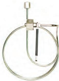
В соответствии с DIN 477/ 230 бар, с шестигранной гайкой, трубчатый змеевик диам. 6 мм. Материал: нерж. сталь / ПТФХЭ. Выход, накидная гайка M14 x 14,5 или NPT 1/4"m. Пигтейловая трубка позволяет соединить панель для управления подачей газа с источником газа в ограниченном пространстве. Встроенные ручки обеспечивают беспотенциальные и газонепроницаемые соединения. Соединения для баллонов согласно другим стандартам, в частности, AFNOR, NEN, ... или баллоны на 300 бар по запросу.
