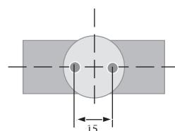
Вентиль имеет 2 отверстия M6 в днище.
