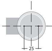
На поверхности MVA 3100 W предусмотрены 2 отверстия M6 для монтажа.
