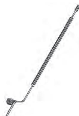
В соответствии с DIN 477/ 230 бар, трубка диам.1/8", с шестигранной гайкой, выход NPT 1/4"m. Материал нержавеющая сталь/ ПТФХЭ. Соединения для баллонов согласно другим стандартам, в частности, AFNOR, NEN, ... по запросу.
