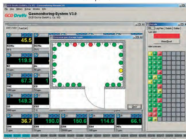
GasCom, графический дисплей для индикации давления в баллонах с функциями аварийной сигнализации и индикаций низкого давления подачи газа
