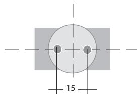
На поверхности MVR-A 3100 G предусмотрены 2 отверстия M6 для монтажа.
