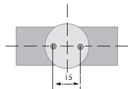
Вентиль имеет 2 отверстия M6 в днище.
