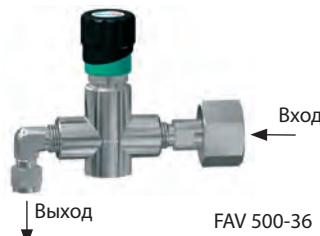
**Вентиль с соединением для подключения баллона, для инертных, реактивных, горючих и окисляющих газов и смесей, кроме кислорода, чистота макс. 6,0, давление на входе 50 бар / 725 фнт/кв.дюйм**
