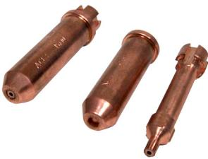
Para soplete CH70. Boquilla compacta de 58mm de largo, llama de precalentamiento con efecto de cortina para proteger la pureza del oxígeno y brindar un corte de excelente definición. Su bajo consumo de acetileno permite limitar las deformaciones sobre chapas delgadas y permite cortes hasta 300 mm (12").
