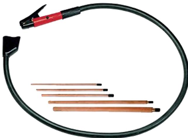
Antorchas Arco Aire y électrodos de carbono. El proceso Arco Aire corte elimina por fusión metal, no químicamente como en oxicorte. El ranurado o corte se produce cuando el intenso calor del arco entre el electrodo de carbono y la pieza funde el metal y al mismo tiempo, el aire pasa a través del arco con la suficiente velocidad para soplar el material fundido.
