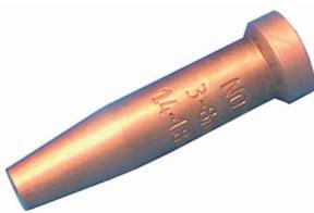
Para soplete X 11. Boquilla compacta (44 mm) de cobre telurio, duradera con 6 canales de precalentamiento. Superficie del canal de corte con efecto pulido para un flujo laminar.
