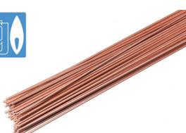
Para la soldadura de aleaciones bronce y del cobre. Soldadura de tubos de cobre y de tuberías por capilaridad. Aleación cuaternaria de cobre-fósforo-plata-níquel, con 6% de plata certificado ATG para la soldadura de canalizaciones de gas en baja presión.
