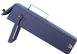
Para mantener los electrodos en un recinto seco y caliente, hasta el momento de usarlos.
