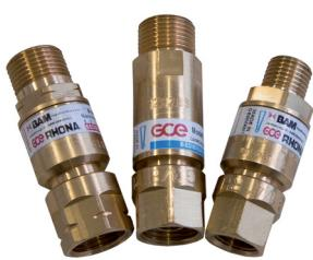
FR20 es un dispositivo robusto pero liviano especialmente diseñado para sopletes. Cuerpo completamente de bronce compatible con los gases más comunes industriales, fabricado acorde a la norma EN 730 e ISO 5175. Con filtros de metal sinterizado de alta capacidad previenen la entrada de materia a la unidad, garantizando un gran flujo para aplicaciones de oxicorte mecanizado.
