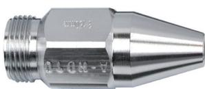
Boquillas interna y externa cromada para reflejar el calor, una larga duración de vida y parámetro de corte estables. Diseño eficiente de los canales de corte para maximizar el efecto Laval y alcázar velocidades de oxígeno superiores a la del sonido, para un corte 30% más rápido que una boquilla estándar.
