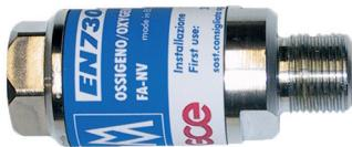
Las válvulas de seguridad MV93-RP a montar a los reguladores dan un caudal máximo de 50m<sup>3</sup>/h (Oxígeno), 12 m<sup>3</sup>/h (GLP) y 6 m<sup>3</sup>/h (Acetileno), para el corte hasta 300mm. son fabricadas acorde a la norma EN730-1. Su cuerpo macizo esta niquelado para ambientes industriales y agresivo.
