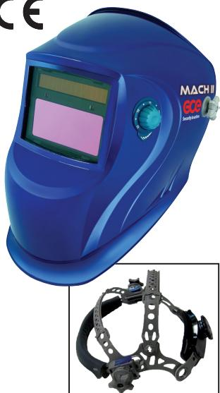
Máscara LCD diseñado específicamente para la soldadura TIG, funciona con baterías y células solares. Este casco ofrece un óptimo desempeño gracias a la rápida reacción de tiempo (0,05 ms), a la doble capa de filtro de LCD y el nuevo casco más cómodo.
