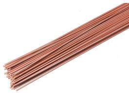
Para la soldadura de aleaciones de cobre. Soldadura de tubos de cobre y de tuberías. Aleación de cobre con 7% de fósforo con bajo punto de fusión para la soldadura del cobre sin usar desoxidantes.
