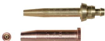
Para soplete X531, X 511, X 21. Boquilla de 87 mm de largo con 18 canales de precalentamiento. Boquilla de alta definición, duradera, para un corte limpio/rápido/profesional con propano, gas natural o mezclas. Cada boquilla es probada individualmente para garantizar una perfecta definición de la llama y del corte. Superficie del canal de corte con efecto pulido para un flujo laminar.
