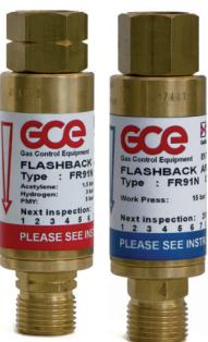
Los arresta llama FR91N son dispositivos de seguridad de alto caudal de 3 funciones. Su filtro sinterizado de gran capacidad permite suministrar grandes flujo a la salida de un panel de regulación o de un punto de uso de gran capacidad. Cumpliendo las normas EN730 y ISO 5175
