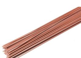
Para la soldadura de aleaciones bronce, del latón y del cobre. Soldadura de tubos de cobre y de tuberías por capilaridad. Aleación de fósforo y cobre con 15 % de plata, para la soldadura del cobre y del bronce y uniones que pueden sufrir calentamientos hasta 400°C sin sufrir cambios en sus características.
