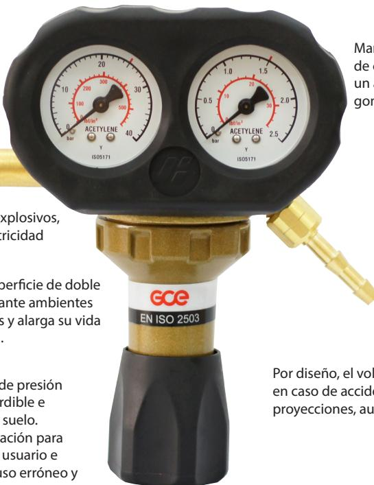
Manómetros de doble escala (Bar y Psi) de clase de presión 2,5, protegido por un armazón cincado y un protector de goma auto extingüible
