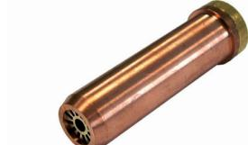
Para el soplete RAFALE, boquilla maciza de 67.5 mm de largo, con 12 canales de precalentamiento, para corte de espesores de hasta 1 metro.
