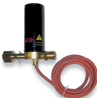
Calentador de alta presión (para hasta 200 bar o 3000 Psi de presión de cilindro), con cuerpo y conexiones de bronce, se ubica entre el cilindro y el regulador.
