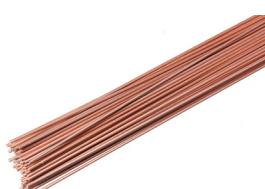
Para la soldadura de aleaciones de cobre. Soldadura de tubos de cobre y de tuberías por capilaridad. Aleación ternaria de cobre, fósforo y 2 % de plata, para la soldadura de aleaciones de cobre. Soldadura idónea con distancias entre paredes de tubo de 0,05 a 0,13mm (.002-.005").
