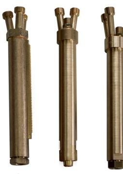
Hay disponible un soplete de corte con mezcla positiva y dos variantes de sopletes de corte de inyector. Soplete de corte de inyector BIR Mini debe ser utilizado con boquillas de corte de dos piezas enroscadas en la cabeza del soplete. FIT Mini esta diseñado con un confiable y único asiento plano. Los tipos gas combustible tienen que ser considerados en caso de sopletes de inyector. Todos los sopletes cumplen con la norma ISO 5172.
