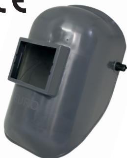
El casco EURO esta hecho de fibra de vidrio reforzado de poliamida de alta resistencia. Casco robusto y profesional, resistente al calor, con un reposa cabeza confortable para trabajos de larga duración. Gran protección del soldador gracias a sus dimensiones generosas : 380x260x210 mm. Área de visión de 90 x 110 mm.
