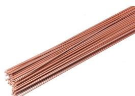
Para la soldadura de aleaciones bronce y del cobre. Soldadura de tubos de cobre y de tuberías por capilaridad. Aleación ternaria de cobre, fósforo y 5 % de plata, para la soldadura del cobre y del bronce. Soldadura con efecto capilar para distancias entre paredes de tubo de tolerancias difícil de controlar de 0,08 a 0,13mm (.003-.006").
