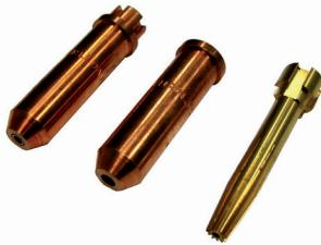
Para soplete CH70. Boquilla compacta de 58mm de Largo, con 12 canales de precalentamiento. Boquilla, idónea para desguace y demolición con su llama de precalentamiento fuerte y agresiva para un arranque rápido, hasta sobre metales oxidados, pintado o galvanizados.
