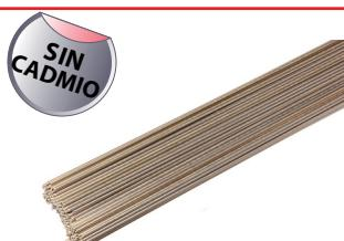
Soldadura fuerte de los cobres, bronces, metales ferrosos, aleaciones con níquel y soldadura de los aceros inoxidables, todo los metales, salvo el aluminio. Aleación cuaternaria de cobre-plata-zinc-estaño de uso universal. Sin cadmio ni plomo para soldaduras libres de componentes tóxicos.
