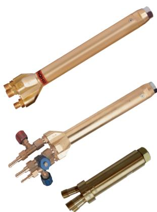
Los sopletes de oxicorte BGR y X541 son sistemas de alta presión con mezcla en la boquilla. Diseño robusto y fiable que permite mantener los 3 gases separados hasta la boquilla.
