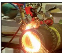
Máquina de corte portátil PCM robusta, pero de un peso ligero para cortes en ángulo recto o bisel con oxígeno - acetileno/propano, gas natural. El cuerpo de la máquina esta fabricado con una base de aleación ligera. El movimiento del soplete se realiza de forma manual mediante un engranaje, longitud estándar de 2,2mm (aproximadamente 7 pies - 8"). El conjunto estándar viene provisto de ruedas planas para su fácil movimiento en la superficie del tubo.
