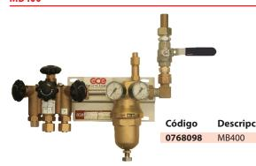
Central de alta presión basado en la unidad Manyflow para aplicaciones de caudal elevado. Puede utilizarse con oxígeno y gases inertes. Se ha diseñado principalmente para su servicio con baterías de cilindros. Consta de válvulas anti-retorno en las entradas del Manyflow, válvulas de corte individuales y una válvula de corte central. El regulador MR 400 contiene manómetros de alta presión y de baja presión y una válvula de seguridad.
