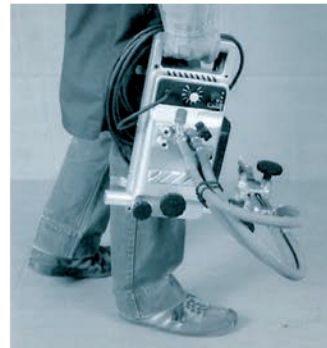
ProFIT ist aufgrund eines Leichtmetallgehäuses bequem tragbar
