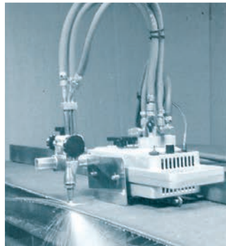
ProFIT für automatische Geradeschnitte durch Winkelprofilführung
