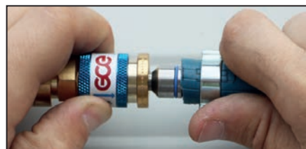
2. Ziehen Sie die blaue Hülse der Schnellkupplung zurück und führen dann den Kupplungstift fest ein.
