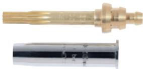
Para soplete X511, boquilla de fuerte calentamiento idónea para corte con polvo de hierro, sopletes de emergencia en acerías, corte en sitios confinados. Superficie del canal de corte con efecto pulido para un flujo laminar. Cada boquilla es probada individualmente para garantizar una perfecta definición de llama y corte.
