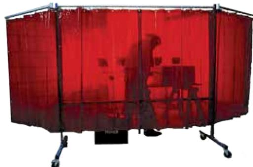
Se trata de cortinas protectoras móviles que vienen equipada con ruedas para mayor comodidad. Su estructura estable está construida en secciones de 50 × 30 mm con tubos de acero cubierto con tratamiento de multi capas resistente a la corrosión (pintura epoxi) y con dos secciones laterales móviles, convenientes para delimitar el área de trabajo. La cortina está sujetada a la estructura mediante ganchos metálicos incluidos. El conjunto completo incluye la cortina con 0,4 mm de espesor (o 1 mm).
