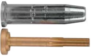
Para soplete X 11, boquilla de corte con Propano compacta (44mm) y duradera, doble cromado para un mejor disipación del calor. 10 canales de precalentamiento para un corte de buena definición. Superficie del canal de corte con efecto pulido para un flujo laminar.
