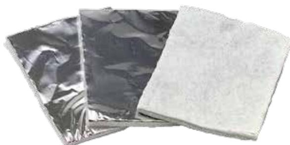
ISOL'DAVES es una pantalla de protección térmica adecuada para proteger las superficies y objetos del calor durante la operación de soldadura in situ. Es una cubierta hecha de fibras de sílice (lana) y punzonada con una capa de aluminio antipolvo. Adecuado para todo tipo de protección térmica.
