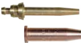
Para soplete NM250, X 511, X 21. Boquilla de 87 mm de largo con 18 canales de precalentamiento. Boquilla de alta definición, duradera, para un corte limpio/rápido/profesional con Propano, Gas Natural o mezclas. Cada boquilla es probada individualmente para garantizar una perfecta definición de la llama y del corte. Superficie del canal de corte con efecto pulido para un flujo laminar.
