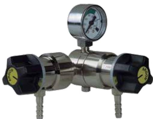
Gracias a las 3 salidas, cuyo caudal puede ser ajustado de forma independiente, podemos usar una sola botella para suministrar gas a 3 máquinas de soldar al mismo tiempo, esto es posible porque las máquinas TIG no requieren un alto caudal de gas y el regulador COMBIFLOW puede trabajar con bajos caudales de gas.
