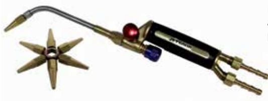
El soplete Jetsoud es una herramienta ligera y fácil de manejar, con una gran flexibilidad en el ajuste de la llama. Permite soldar hasta 5 mm de espesor. El soplete incluye un estrella con 6 puntas (63, 100, 160, 250, 315, 400 l)
