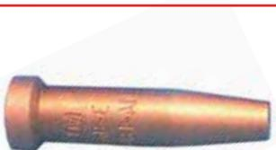
Para soplete X 11. Boquilla compacta (44 mm) de cobre telurio, duradera con 6 canales de precalentamiento. Superficie del canal de corte con efecto pulido para un flujo laminar.
