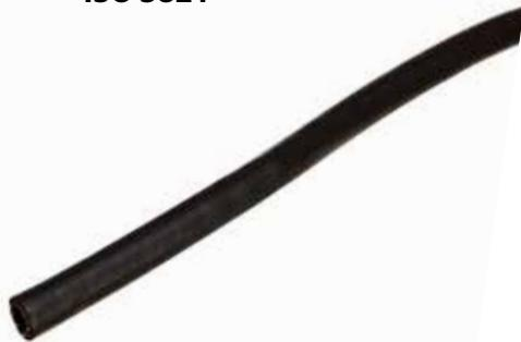
Manguera de goma para uso con argón en procesos de corte y la soldadura y afines. Válida para hidrógeno, CO2 y nitrógeno para corte y soldadura. No apta para LPG, MPS y CNG.
