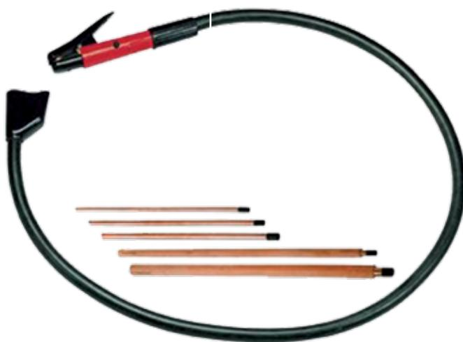
Antorchas Arco Aire y electrodos de carbono. El proceso Arco Aire corte elimina por fusión metal, no químicamente como en oxicorte. El ranurado o corte se produce cuando el intenso calor del arco entre el electrodo de carbono y la pieza funde el metal y al mismo tiempo, el aire pasa a través del arco con la suficiente velocidad para soplar el material fundido. Los elementos de protección y seguridad adecuados para protegerse del ruido, calor, humo e intensa luz que genera este proceso.
